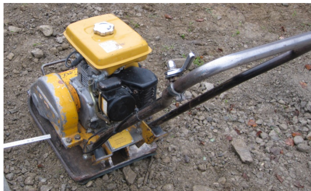
Bild 29: Verdichten nur mit sehr leichten Verdichtungsgeräten
