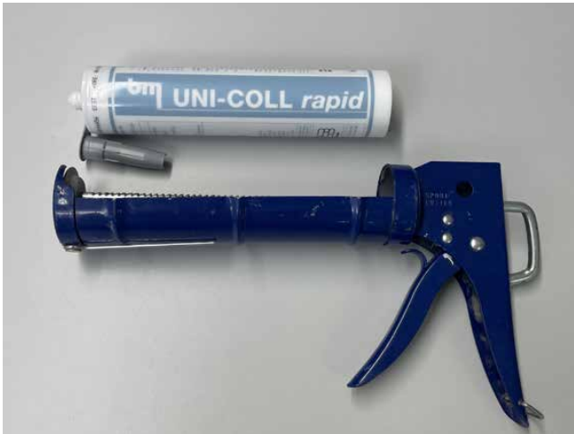
Illustration 4 : Pistolet pour cartouche de 290 ml
