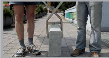
PINCE DE LEVAGE AVEC MÂCHOIRES EN CAOUTCHOUC
