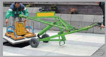
PRESTO APPAREIL DE POSE POUR DALLES
