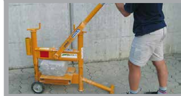
FENDEUSE DE PIERRE POUR BRIQUES SANTURO®
