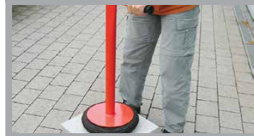
PORTE-DALLES PNEUMATIQUE PAR VIDE D'AIR
