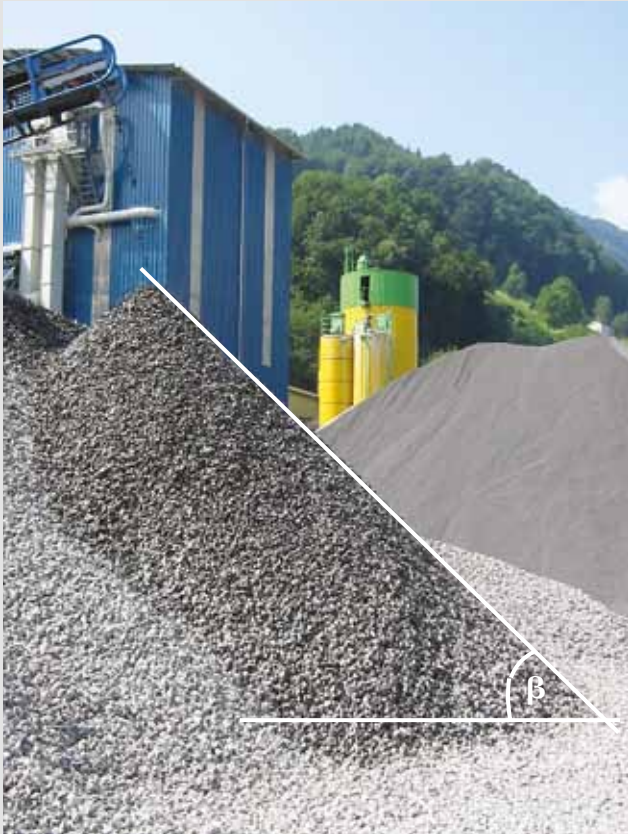
Natürlicher Böschungswinkel \beta
