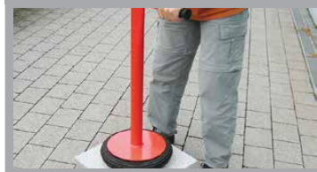
PORTE-DALLES PNEUMATIQUE PAR VIDE D'AIR
