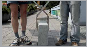
PINCE DE LEVAGE AVEC MÂCHOIRES EN CAOUTCHOUC
