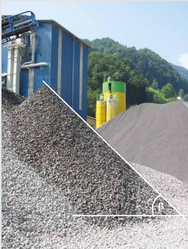
Natürlicher Böschungswinkel \beta
