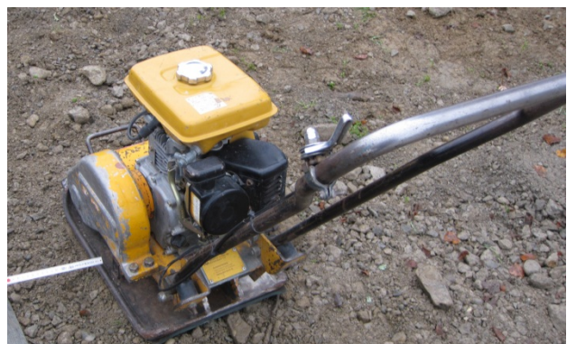
Bild 42: Verdichten nur mit sehr leichten Verdichtungsgeräten
