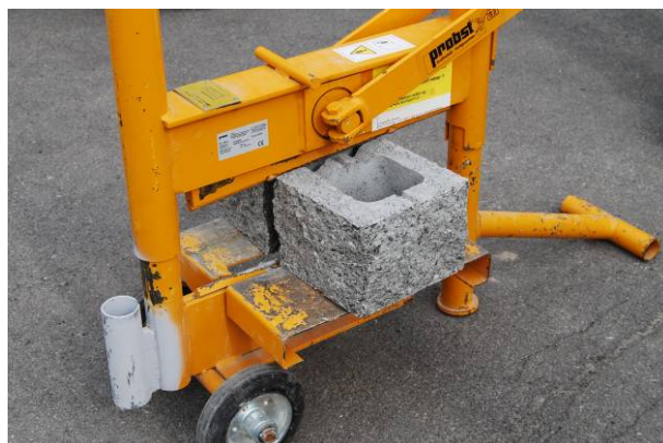
Bild 54: Trennen der Spaltsteine mit Steinspalter
