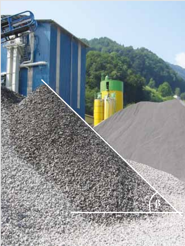
Natürlicher Böschungswinkel \beta
