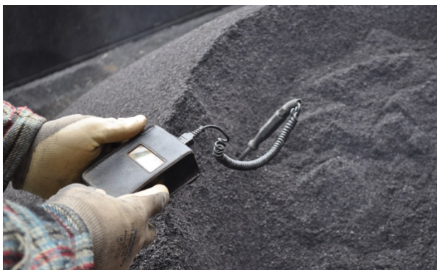
Bild 20: Kontrolle der Einbautemperatur
