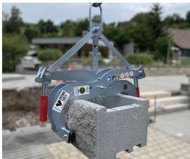
Illustration 5 : pose à l'aide de la pince TSZ-Uni
