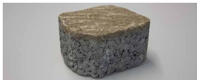
noyau en béton filtrant
