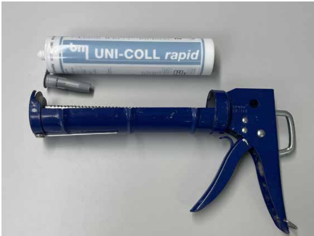
Illustration 4 : Pistolet pour cartouche de 290 ml
