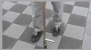
FERS ALIGNEURS POUR PAVÉS CLASSIQUES ET AUTOBLOQUANTS
