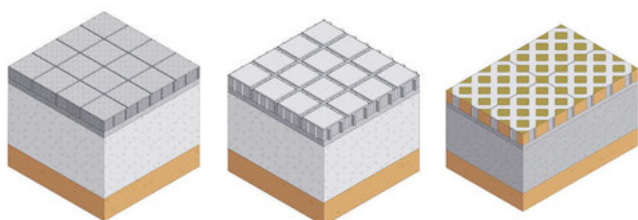
Bild 3: Gegenüberstellung Sicker-, Öko- und Rasengittersteine (v.l.n.r.)
