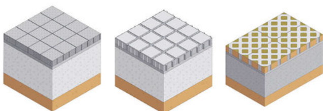
Bild 3: Gegenüberstellung Sicker-, Öko- und Rasengittersteine (v.l.n.r.)
