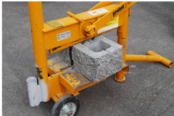
Bild 54: Trennen der Spaltsteine mit Steinspalter
