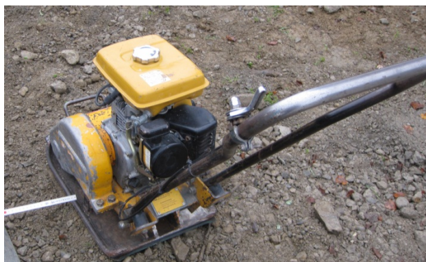
Bild 42: Verdichten nur mit sehr leichten Verdichtungsgeräten
