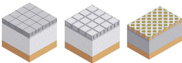
Bild 3: Gegenüberstellung Sicker-, Öko- und Rasengittersteine (v.l.n.r.)
