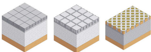
Bild 3: Gegenüberstellung Sicker-, Öko- und Rasengittersteine (v.l.n.r.)
