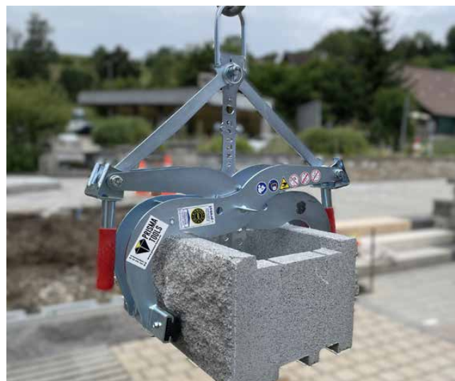
Bild 5: Versetzen mit Trittstufenversetzzange TSZ-Uni
