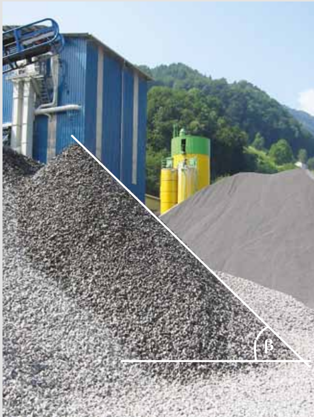
Natürlicher Böschungswinkel \beta
