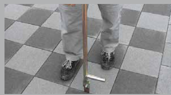
RICHTEISEN FÜR PFLASTER- UND VERBUNDSTEINE
