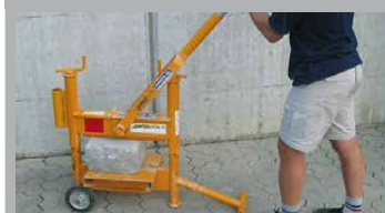
STEINSPALTER FÜR SANTURO® MAUERSTEINE
