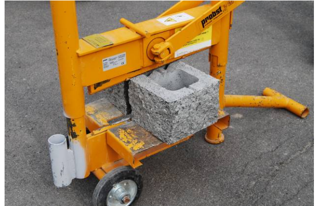
Bild 54: Trennen der Spaltsteine mit Steinspalter
